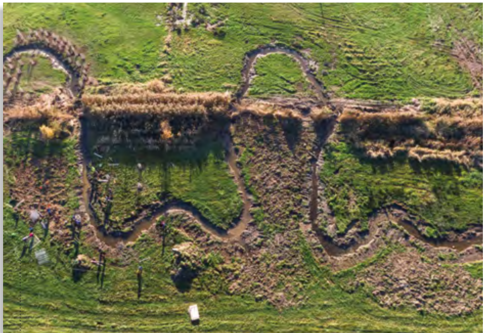
Der Bach Lossa (bei Wurzen) findet wieder in seinen ursprünglichen Verlauf zurück. Die Alt-Arme wurden dafür unter fachkundiger Anleitung des Ingenieurbüros Stowasserplan wiederhergestellt
